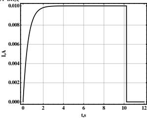
6. Как и прежде, при вытаскивании рамки из постоянного магнитного поля в ней индуцируется э.д.с. индукции, которая определяется законом Фарадея (1). Помимо этого, действует э.д.с. самоиндукции сверхпроводящей рамки
