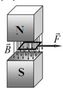
2. При вытаскивании рамки из постоянного магнитного поля в ней возникает э.д.с. индукции, которая определяется законом Фарадея
