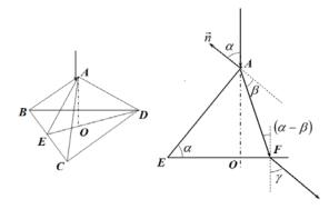
основание пирамиды. Высота боковой грани  $|AE|=\frac{a}{2}$ , высота пирамиды  $|AO|=\frac{a}{2}\sin\alpha=\frac{a}{2}\sqrt{\frac{2}{3}}=0,41$ мм . Тогда длина отрезка  $|OF|=|AO|tg(\alpha-\beta)=0,24$  мм . Окончательно получаем, что эта точка лежит на расстоянии  $|DF|=|OD|-|OF|=\frac{a}{\sqrt{3}}-0,24$ мм = 0,91мм .
