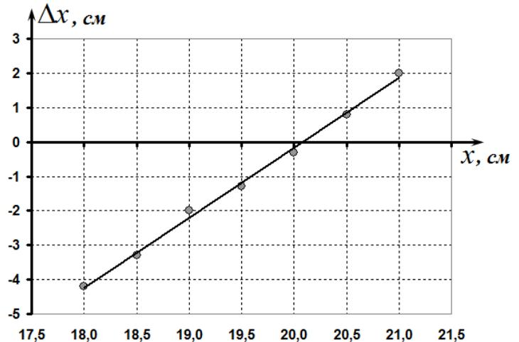
Коэффициент наклона этой зависимости, рассчитанный по МНК равен  $K_3 = 2,03 \pm 0,10$ . Соответственно, фокусное расстояние линзы
