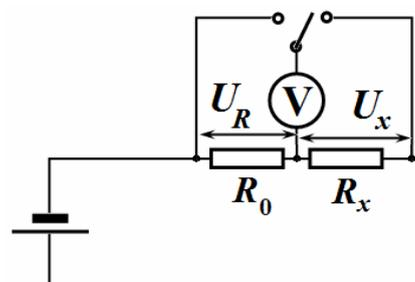
Таким образом, для измерения неизвестного сопротивления необходимо измерить напряжения на измеряемом и известном резисторах.
