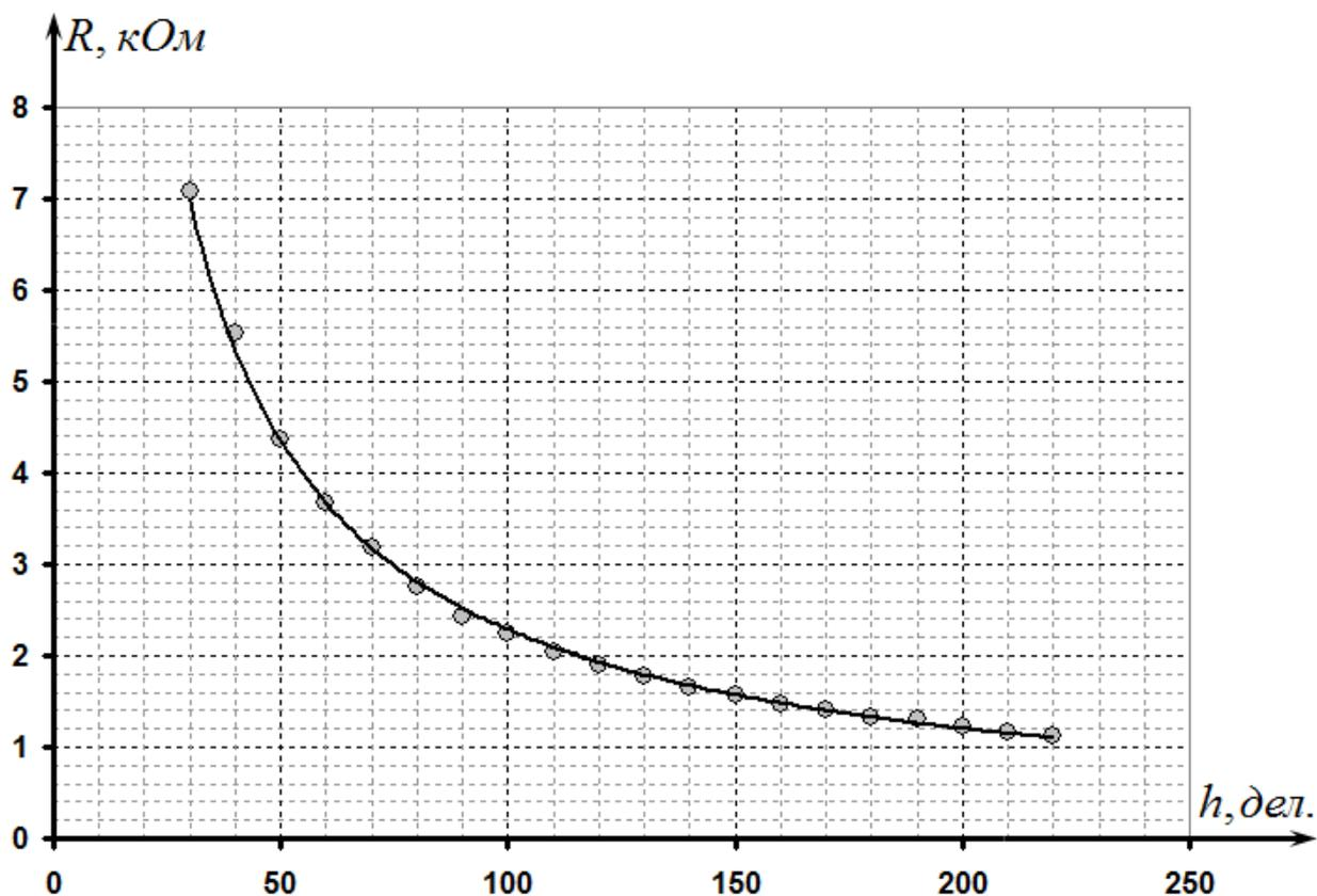
Простым измерением легко установить, что объему  $V_0 = 200 \text{ мл}$  соответствует высота  $h_0 = 170 \text{ мм}$ . Поэтому высота уровня налитой жидкости рассчитывается по формуле  $h = V \frac{h_0}{V_0}$ , то есть цена деления  $\delta = 0,85 \frac{\text{мм}}{\text{мл}}$ .
