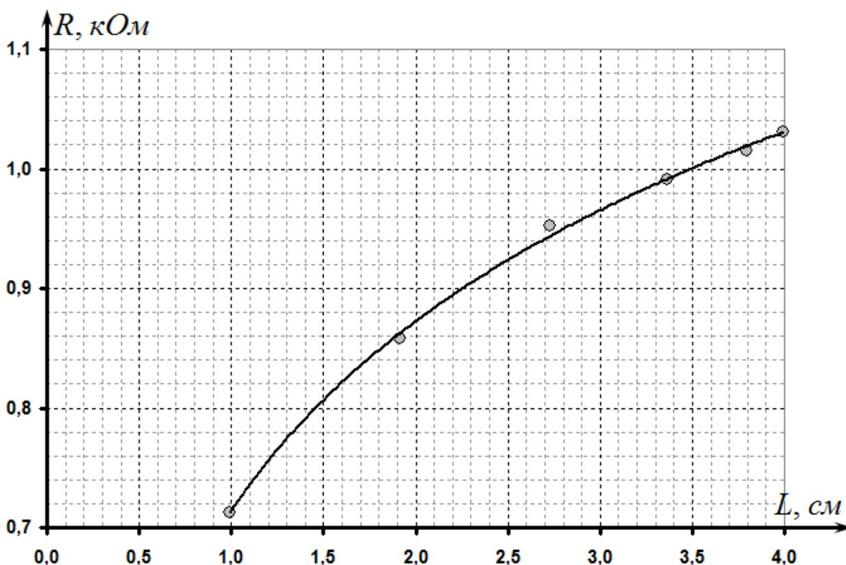
3.2 Теоретически можно показать, что сопротивление среды между двумя длинными параллельными электродами в бесконечной среде определяется по формуле
