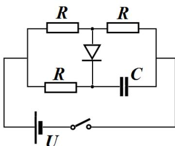
Изображённая на рисунке схема состоит из конденсатора ёмкостью  $C = 100$  мкФ, идеального диода, источника постоянного напряжения  $U = 10,0$  В, трёх одинаковых резисторов сопротивлением  $R = 10,0$  кОм и ключа. В начальный момент конденсатор не заряжен, ключ разомкнут. После замыкания ключа ток через диод идёт в течение времени  $\tau = 462$  мс, а затем прекращается.
