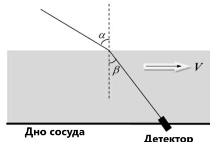
При скорости воды  $V \ll c$ , выражение для синуса угла  $\beta$ , под которым детектор фиксирует излучение, имеет вид
