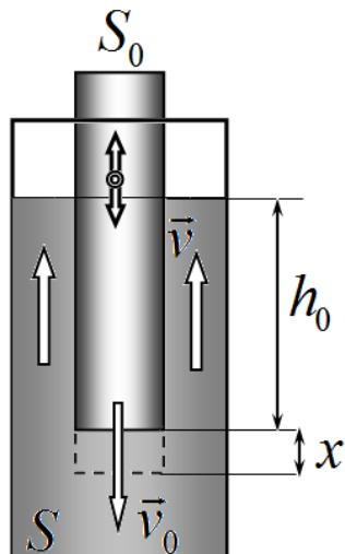
A2. Пробирку помещают в цилиндрический сосуд с площадью поперечного сечения  $S$ , заполненный водой. Пробирка совершает малые колебания вдоль оси сосуда.
