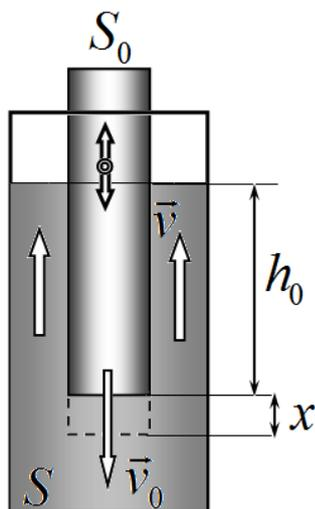
A2. Пробирку помещают в цилиндрический сосуд с площадью поперечного сечения  $S$ , заполненный водой. Пробирка совершает малые колебания вдоль оси сосуда.
